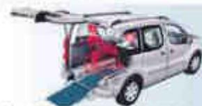
Bei einer Rollstuhlbeförderung werden die original montierten Sitzbänke abgebaut und nach vorne gelagert. Bitte beachten Sie die Fahrzeuglast.
